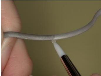
＜金属接着性プライマー処理＞
